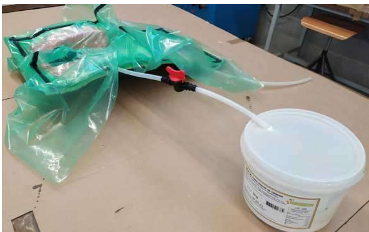
Robinet et Seau pour faire le réservoir de résine pour l'infusion
