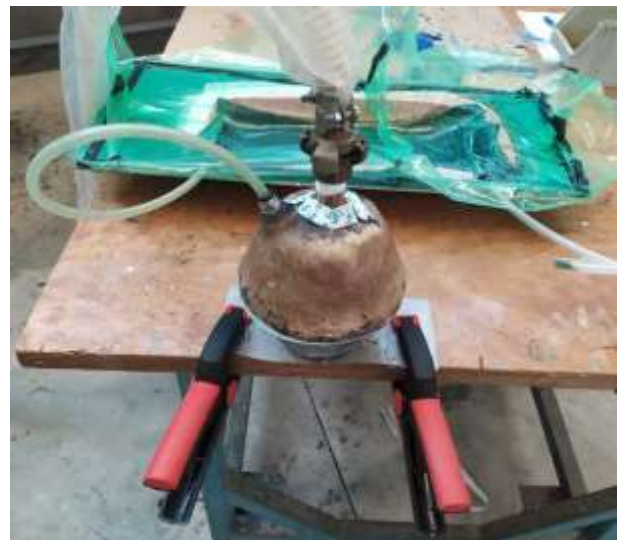
Montage d'infusion avec piège à résine
