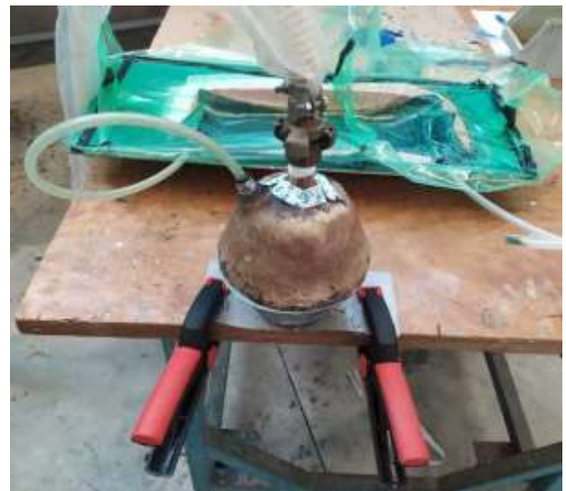
Montage d'infusion avec piège à résine
